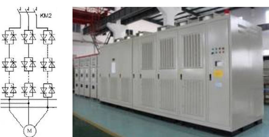
Abb. 3: Schematischer Aufbau eines Hochspannungs-Softstarters
